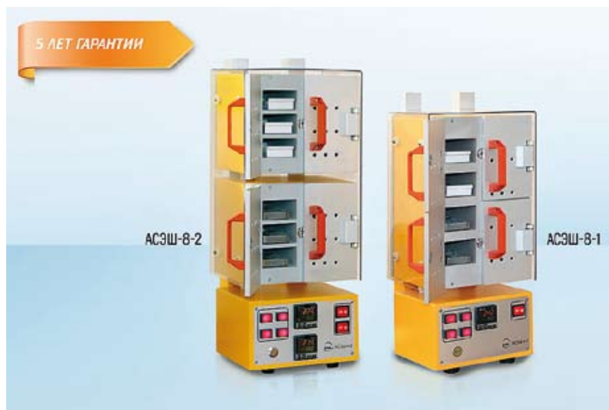
Рис. 1. Измерительные воздушно-тепловые установки АСЭШ-8
