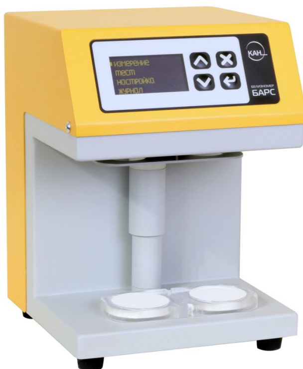
Рисунок 1. Внешний вид белизномера.
