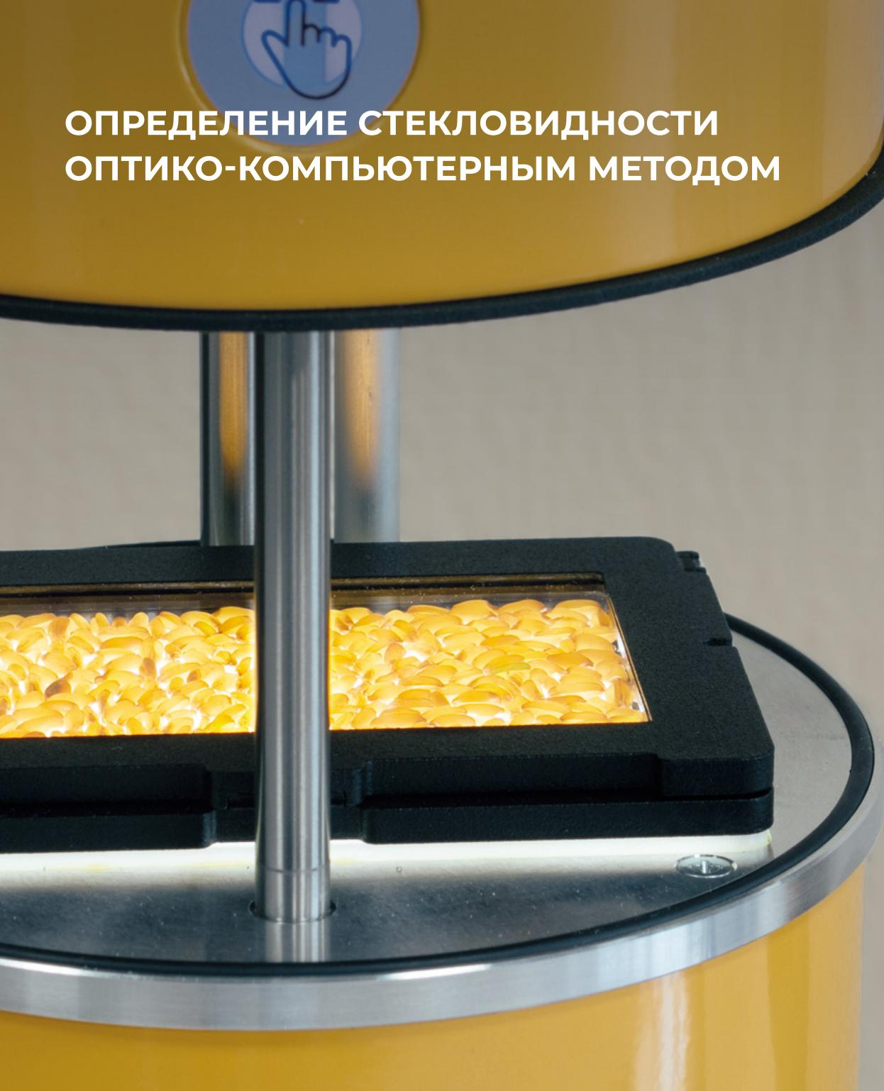
Автоматизация процедуры определения стекловидности позволяет исключить субъективный фактор, повысить точность измерений и значительно сократить время, необходимое для проведения анализа.
