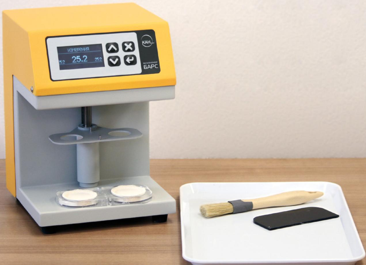
Специализированный прибор для измерения коэффициента диффузного отражения света от муки и определения её белизны в соответствии с действующими стандартами.
