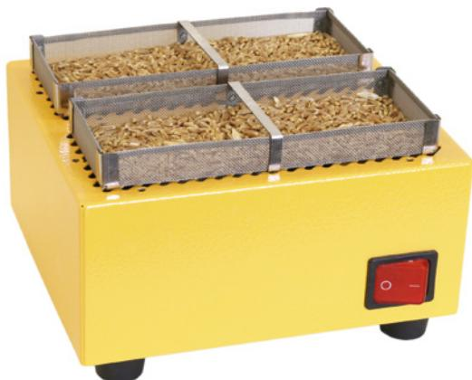
■ Предназначен для ускоренного охлаждения проб зерна, зернобобовых и масличных культур при определении влажности воздушно-тепловым методом.
