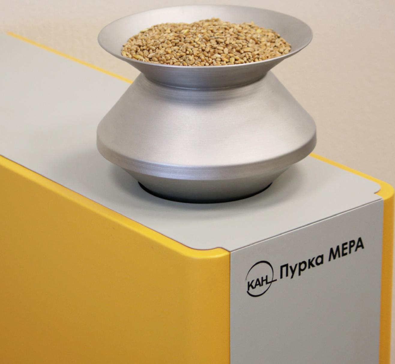
Натура определяется как масса одного литра пробы, выраженная в граммах. Определение натуры проводится путём точного автоматического отмеривания одного литра продукта и последующего его взвешивания.
