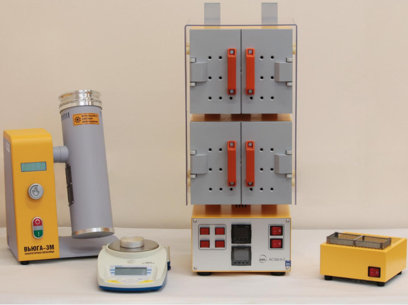
Реализуют термогравиметрический метод, также известный как воздушно-тепловой, который позволяет определить содержание влаги в исследуемом образце. Метод основан на измерении разницы в массе образца до и после высушивания с последующим расчётом значений массовой доли влаги.
