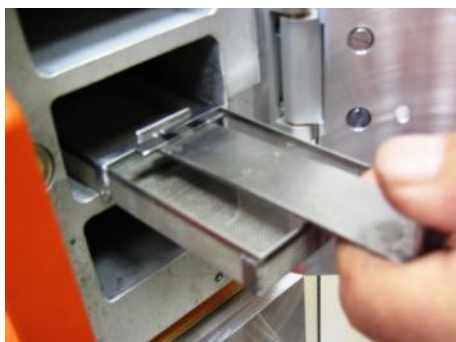
Рисунок 4 - Ручка для загрузки и выгрузки сетчатых бюкс
